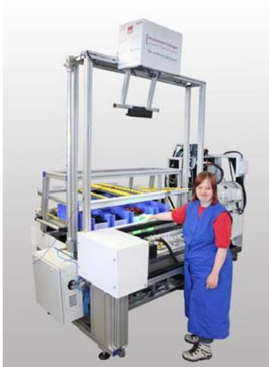
Abbildung 1: Einzelarbeitsplatz mit Assistenzsystem zur Montage von Schraubzwingen
