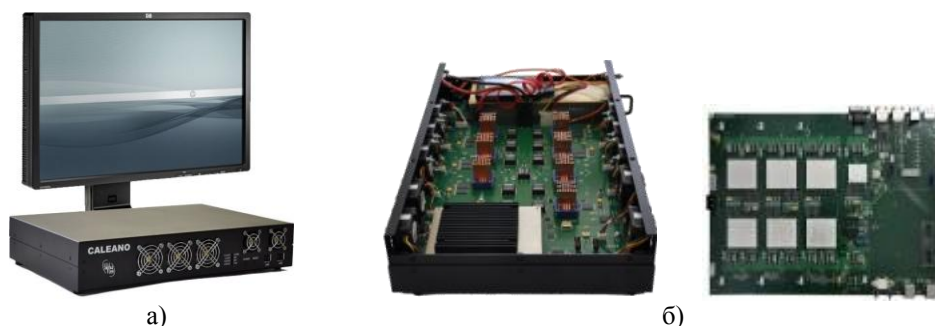
Рис. 1. Фотографии РВБ «Калеано» и его составных частей
